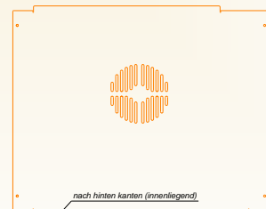
19" Gehäuse Deckel Kantezeichnung und Abwicklung (19"G_220516.DXF)
